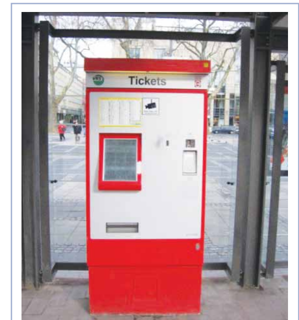
Figura 134: Exemplos de Bilheteiras de auto-atendimento com altura e localização adequadas.
